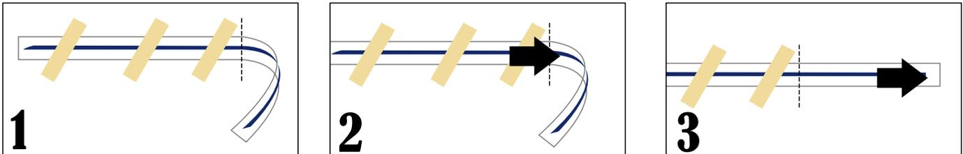
3. Entfernen Sie das Trägerpapier (das mit der aufgedruckten Rasterlinie) und schneiden Sie es in der Nähe der Mitte des Stücks (gepunktete Linie). Dann kleben Sie das marineblaue Vinyl, indem Sie es von der gepunkteten Linie bis zum Ende des Stücks „ziehen“. (Siehe Abbildungen 1, 2 und 3).
