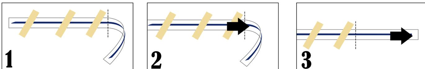
3. Retirez le papier support (celui avec une grille imprimée) et coupez-le près du centre de la pièce (ligne pointillée). Ensuite, collez le vinyle bleu marine en le "glissant" de la ligne pointillée jusqu'à l'extrémité de la pièce. (Voir Figures 1, 2 et 3).
