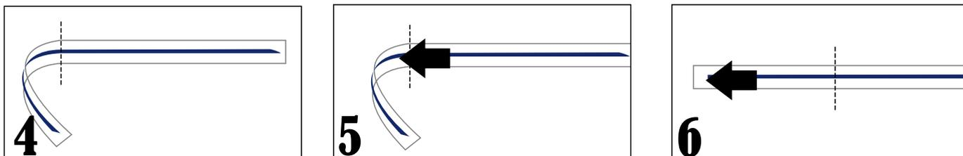
5. Lorsque tout le vinyle bleu marine est collé sur le véhicule, retirez le film de transfert (le film transparent). Assurez-vous que le vinyle adhère correctement ; sinon, frottez-le jusqu'à ce qu'il soit bien fixé à la carrosserie.
